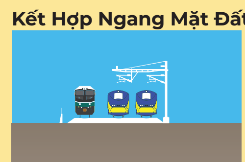
Hai đường ray hành khách dịch vụ kết hợp, chạy điện (với Caltrain) và một đường ray chở hàng không dùng điện
