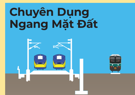
Hai đường ray cao tốc ngang mặt đất kế bên đường ray chở hàng hiện tại
